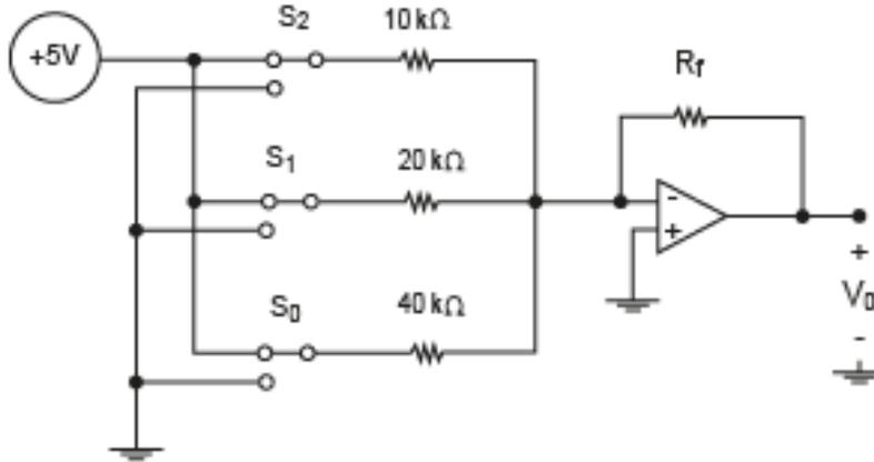
Na situação apresentada, o valor de  $R_f$  para que a saída  $V_0$  do conversor varie de 0 a  $-7\text{ V}$  é igual a:
