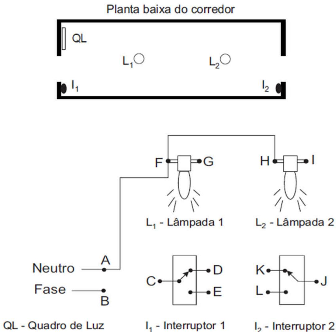
O conjunto das demais conexões para completar a instalação elétrica desejada é dado por:
